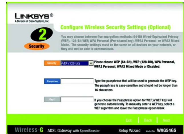
Abbildung 5-30: Setup-Assistent – Fenster Configure Wireless Security Settings (Optional) (Konfigurieren der Wireless-Sicherheitseinstellungen [optional]) – WEP (128-Bit)
